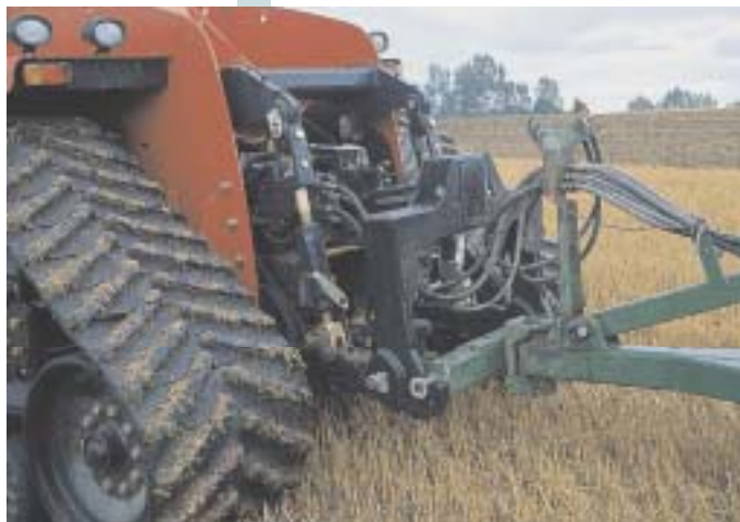
9-тонный подъёмник и вал отбора мощности принадлежат к серийному оснащению европейского Quadtrac.
