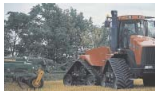
Трансмиссия позволяет разворот без повреждения поля. Несмотря на собственную массу в 22,5 т, давление на почву, благодаря опорной площади в 5,5 м 2 , составляет всего 0,4 бар.
