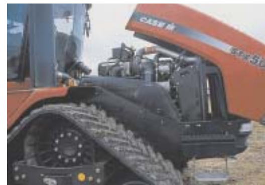
Под огромным капотом работает шестцилиндровый Cummins объёмом 14,9 литров.
