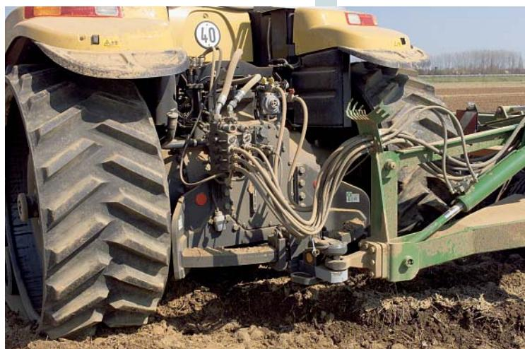
Подъемный механизм и ВОМ являются дополнительным оборудованием, используются только маятниковая наработка и несколько гнезд гидравлической системы. Для торможения тяжелых прицепных орудий предлагается в серийном оснащении компрессорная установка.
