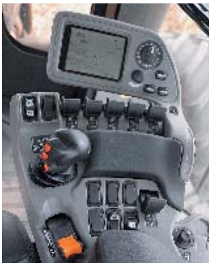
На панели удобно размещены элементы управления всеми функциями, а также 6 гидравлических устройств управления. Ручка настройки позволяет вызывать на экране различные меню и программировать определенные функции.
