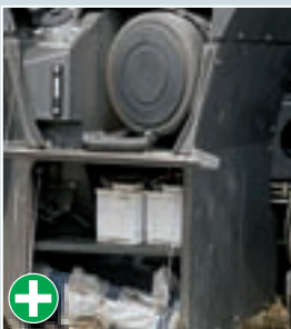
Под воздушным фильтром и аккумуляторной батареей достаточно места для инструментов.
