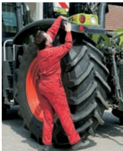
Наружные кнопки управления задней навеской хотя и имеются, но расположены они на высоте два метра.
