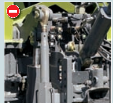
Недостаточный доступ к подключениям пневматики и гидравлики.
