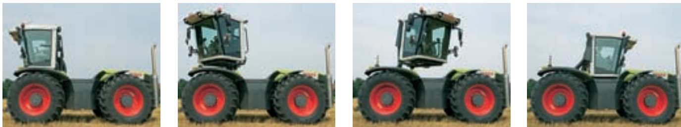
...так вращается кабина: разблокировать, приподнять, развернуть, опустить, зафиксировать – меньше, чем за минуту.
