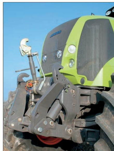
Благодаря литой консоли фронтальный подъемник собственной конструкции выглядит аккуратнее и расположен ближе к передней оси.
