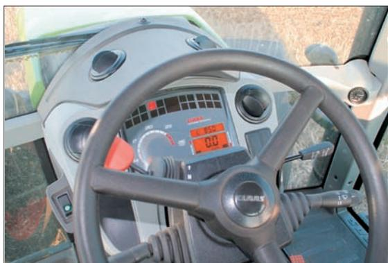
Рычаг управления драйвстик (1), выключатель гидравлики (2), джойстик гидросистемы с кнопками управления (3) – все рядом.
