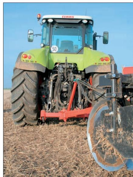
«Аксион» может оснащаться тремя различными вариантами задней оси. Они рассчитаны для машин мощностью от 163 до 260 л.с.
