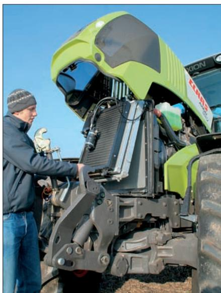
Шестицилиндровыми двигателями «Джон Дир» с четырехклапанной головкой, насосом «коммонрейл» и переменным турбонаддувом оснащены все «Аксионы».
