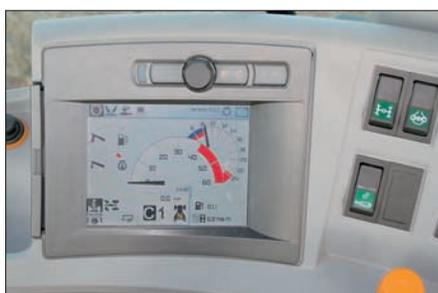
**Дорожный режим:** доминируют указатель числа оборотов двигателя и спидометр. Указатели статуса привода на все колеса и т.д. расположены снизу.
