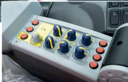
Новшеством является подлокотник с пультом управления Power ComS: за исключением вала отбора мощности (кроме управления с помощью Comfor Tip) и регулировки высоты подъемного механизма, с его помощью можно управлять самыми важными функциями. Под подлокотником находятся ручки управления новой автоматической трансмиссией и автоматикой гидравлических клапанов.
