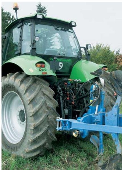
Указанная производителем Deutz-Fahr грузоподъемность составляет 10,5 т. Внешнее управление подъемником и валом отбора мощности расположено по обеим сторонам.
