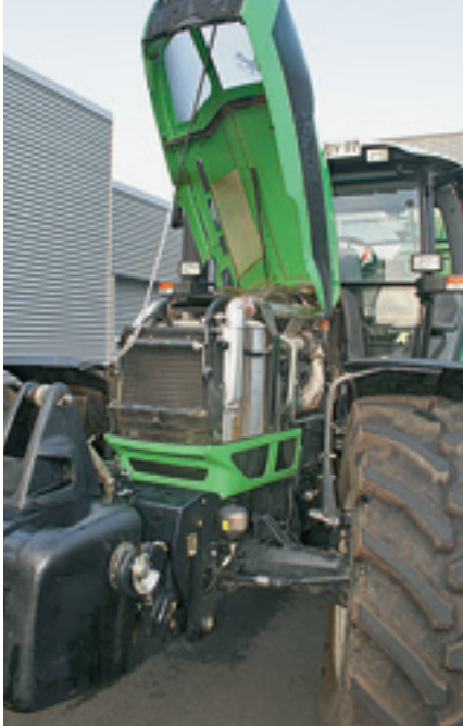
Deutz TCD 2012 L06 с сертификатом Tier III, с системой впрыска CommonRail и внешней системой возврата выхлопных газов.
