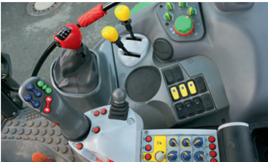
В кабине произошли небольшие изменения, ВОМ подключается теперь нажатием только одной клавиши (необходимо держать 3 секунды).
