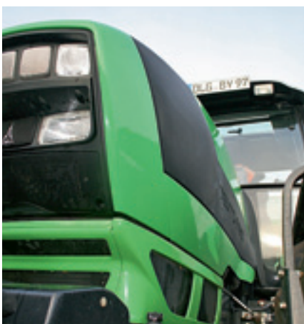
Исчез патрубок впуска воздуха на левой стороне кабины. Двигатель „дышит“ теперь спереди через решетку радиатора.
