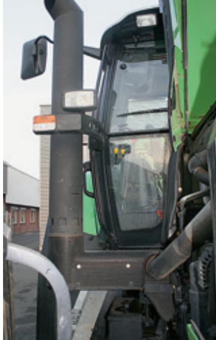
Теперь выхлопная труба закреплена абсолютно свободно и больше не соединена с кабиной.
