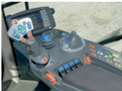
Управление правой боковой консолью (на испытательной стадии) аналогично сегодняшнему Vario 900.
