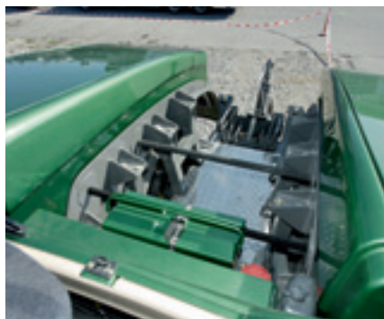
Низкорасположенная площадка в задней части над обеими задними осями позволяет переоборудовать ее в седельную сцепку.
