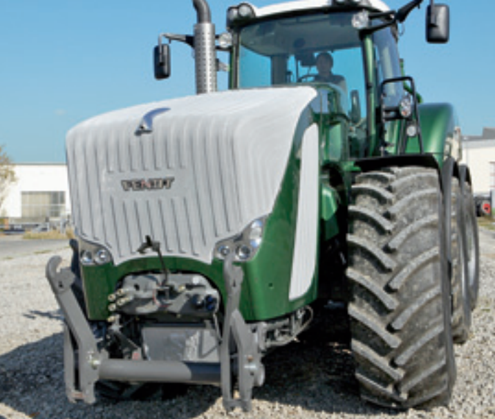
Капот такой же широкий, как и у большого гусеничного трактора, двигатель соответствует нормам токсичности 3В (от 2011 до 2014 года).
