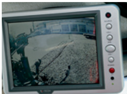
Два дополнительных дисплея находятся в кабине на обеих А-стойках. Первый показывает, что происходит перед капотом,...
