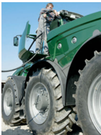
Оба топливных бака, расположенные за задними колесами, вмещают в себя 1360 л дизеля и соединены между собой. Передняя облицовка на обеих сторонах откидывается и дает доступ для заправки.
