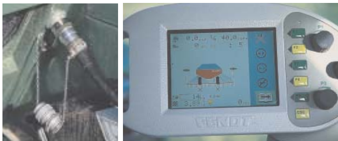
ISO-BUS: достаточно штепсель в розетку вставить (вверху) и, например у сеялки, становится возможным управление посредством Vario-терминала.
