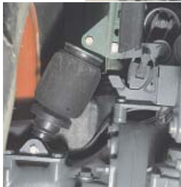
Подъёмный механизм и гидравлика удовлетворяет все пожелания практиков. Новое - пневматическая подвеска кабины (вверху), а также отдельное управление гидроклапаном (справа).
