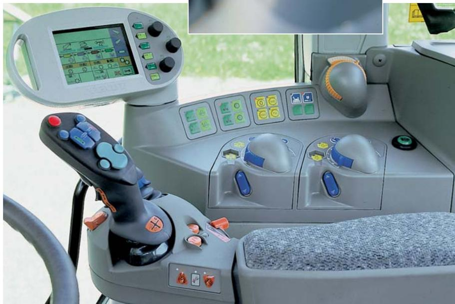
*Между обоими кнопками ручного управления подачей топлива (внизу на подлокотнике) находится кнопка TMS. Спереди на подлокотнике Вы видите красный перекидной рычаг для выбора режимов управления: джойстиком или педалью газа.*
