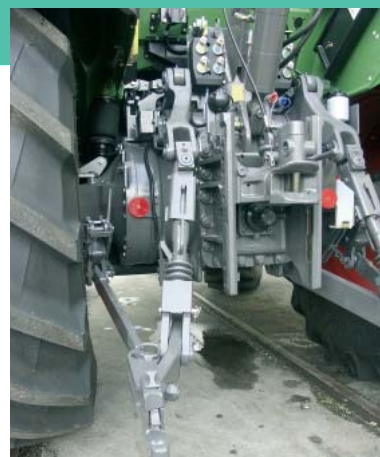
Подъемный механизм у серии 800 Vario особенно прочен и поднимает свыше четырех тонн.
