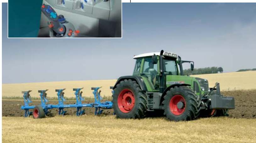
Терминал показывает водителю всю важную информацию. С системой управления на разворотной полосе Variotronic повторяющиеся рабочие процессы автоматизируются.
