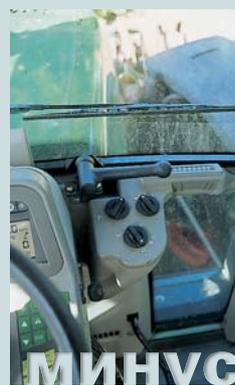
Обслуживание отопления ограничивает не только видимость, оно в комбинации с разделенной вентиляцией в потолке не выглядит современным.
