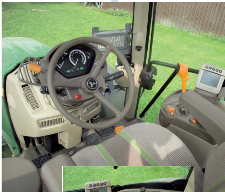
Кабина с четырьмя стойками и панорамными окнами является опцией. При тестировании она продемонстрировала очень хороший круговой обзор.
