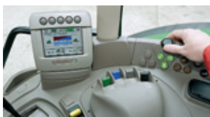
Реостатный регулятор и три зеленые кнопки управления командного центра нам хотелось бы видеть ближе.
