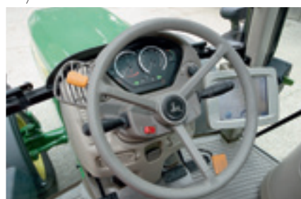
Панель приборов упростилась, к сожалению, отсутствуют цифровые показания скорости в км/ч и ВОМ.
