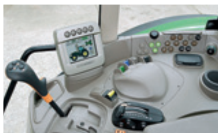
Нам еще не понравилась кулиса рычага переключения скоростей: рычаги систем управления остались труднодоступными.
