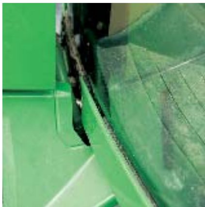
Нервирующее скрипение лобового стекла было устранено лишь после более 1000 моточасов с помощью усадки на силикон.
