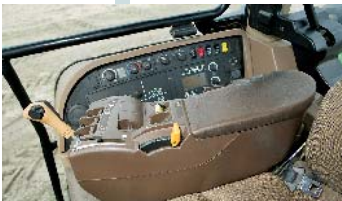
Подлокотник с электрическими клапанами имеется только в комбинации с бесступенчатой коробкой передач. Ручному газу недостаёт шкалы.
