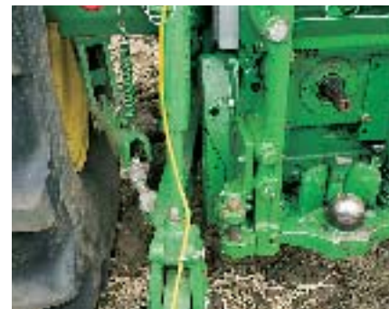
Лишь чугунный ограничитель предотвращает принудительное управление рычагов подъёмника на месте шарнирного соединения.
