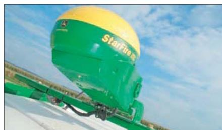
Трактор оснащен одной из лучших систем спутникового управления AutoTrac. Есть только мелкий недостаток: экранирование сигнала деревьями и другими препятствиями лимитирует навигацию.
