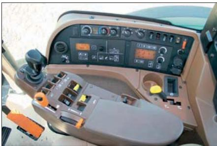
На командном подлокотнике (у бесступенчатых 7030-х – серийно) расположены рукоятка управления подачей топлива, приборы управления, тумблеры включения ВОМ и автоматики управления. При интенсивной эксплуатации неплохо было бы иметь джойстик.
