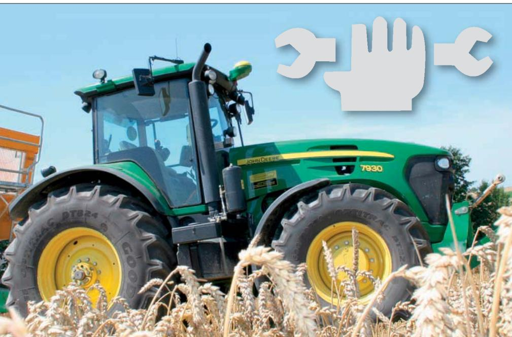
7930-й является «топ-моделью» тракторов фирмы «Джон Дир» в верхнем сегменте среднего класса. Трактор предназначен для крупных хозяйств и предприятий агросервиса и оснащается двигателем мощностью 260 л.с. (191 кВт, ECE R24) и бесступенчатой трансмиссией. На что способна эта машина, проверяли в течение 210 часов наши коллеги из редакции аграрного вестника «dlz».
