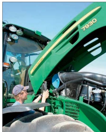
6,8-литровый двигатель из плеяды силовых агрегатов хай-тек «имеет хорошие манеры». Но воздушный фильтр, расположенный вблизи кабины, плохо доступен.
