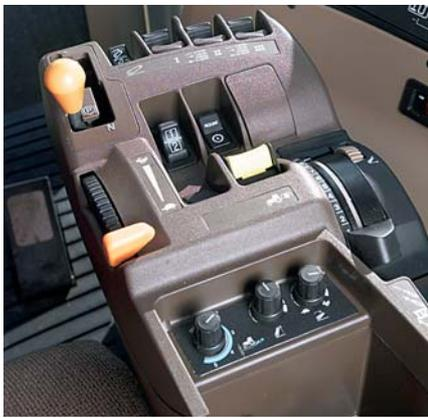
Джойстик переключения передач (рычаг слева вверху) удобен в работе и предназначен для переключения лишь 16 передних и 5 задних скоростей.
