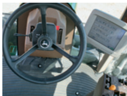
Между двумя видами тракторов почти нет никаких отличий, только в гусеничном тракторе отсутствует педаль блокировки. Все тракторы серии 9030 адаптированы к системам „ISO-Bus“ и „AutoTrac“. Только „GreenStar“-монитор...
