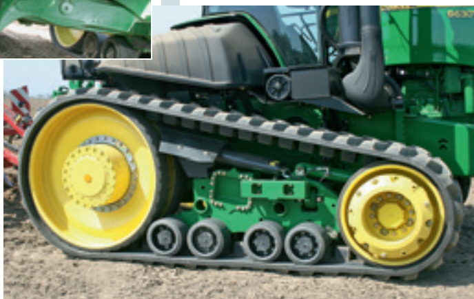
Модель гусеничного трактора с символом „Т“ стоит намного дороже. Натяжение гусеничной ленты обеспечивает цилиндр, который имеет два резервуара с азотом, расположенных в задней части. Новшеством является передний механизм навески в форме ножниц с пневматическим амортизатором (рисунок сверху).
