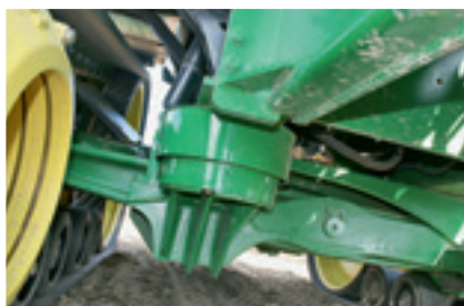
Модель гусеничного трактора с символом „Т“ стоит намного дороже. Натяжение гусеничной ленты обеспечивает цилиндр, который имеет два резервуара с азотом, расположенных в задней части. Новшеством является передний механизм навески в форме ножниц с пневматическим амортизатором (рисунок сверху).
