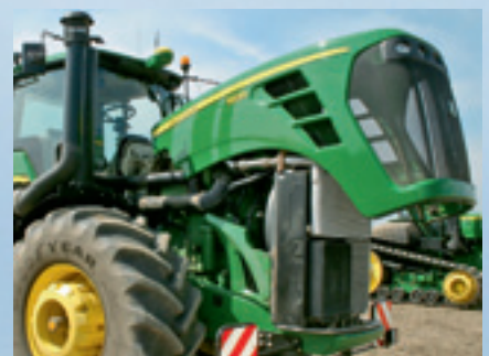
Под мощным цельным капотом расположен двигатель объемом 13,5 л. Опорный вес колесного трактора с шинами 800/70 R38 может достигать 25,8 тонн, гусеничного с 76-см лентами – 24 тонн.
