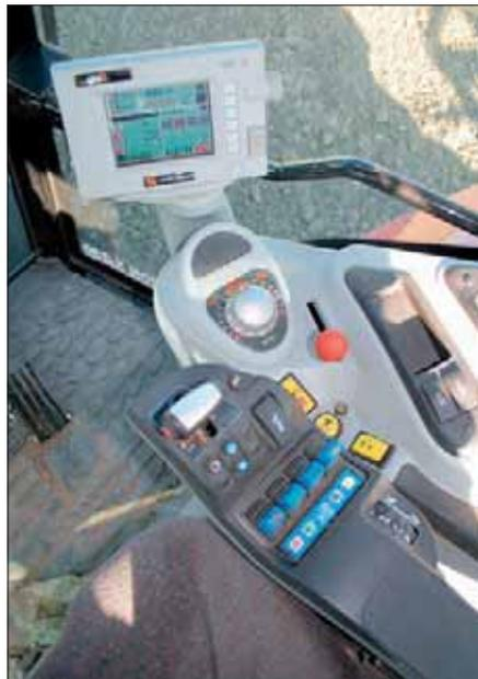
С помощью Т-образной рукоятки можно управлять трансмиссией. Приборы управления хорошо доступны. Для перевода в «плавающее положение» необходимо, однако, использовать дополнительные кнопки.
