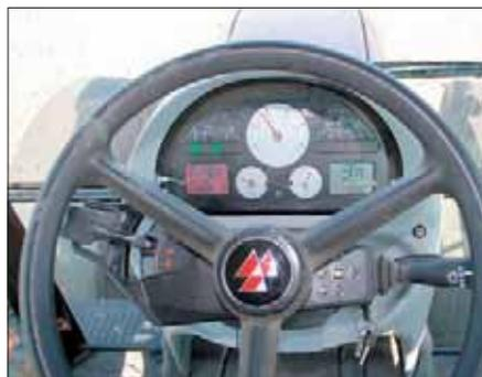
Хороший дисплей с большим числом функций очень важен, однако считываемость при этом затруднена. Кнопки управления расположены справа у рукоятки указателя поворота.
