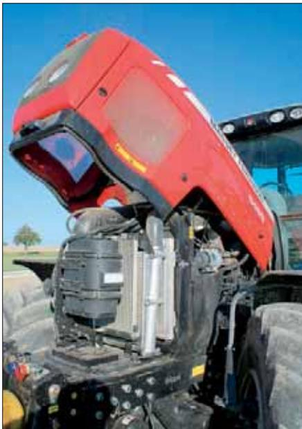
Благодаря насосу «коммонрейл» и четырехклапанной головке шестицилиндровый двигатель с рабочим объемом 7,4 л имеет солидную мощность и экономичен.
