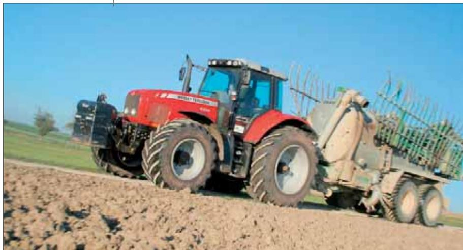
Транспортной скорости 50 км/ч трактор MF 6499 достигает при частоте вращения 1 980 1/мин. Это позволяет экономить топливо. Комфорт при езде – достаточный.
