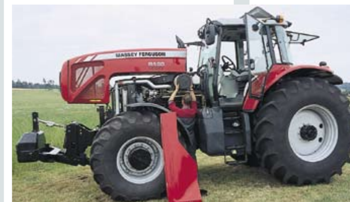
Капот двигателя этого большого трактора открывается, в отличие от меньших моделей, сначала вперед. Потом его можно выставить сзади вверх. Небольшие боковые панели снимаются.
