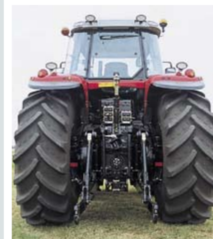
Новое оборудование ITCS для гидравлики с радаром и регулировкой пробуксовки является стандартом
