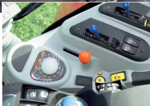
Все переключения автоматической коробки передач производятся большим регулятором.
