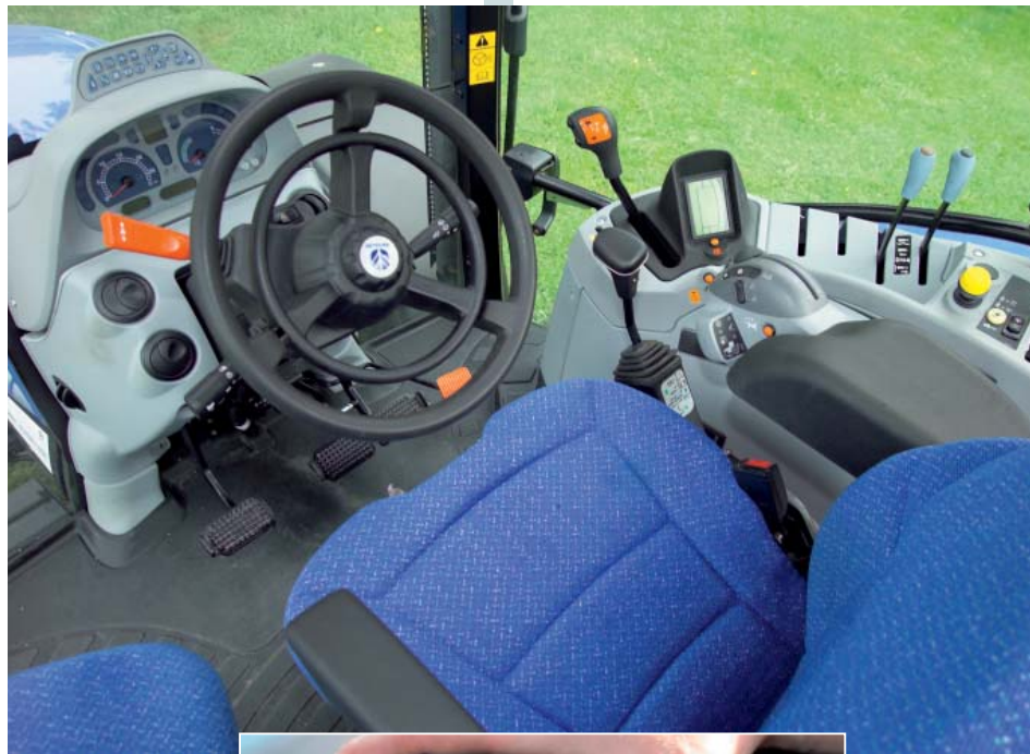
Четырехстоечная кабина New Holland. Оснащение электронными устройствами управления – опционально. В рулевом колесе – управляющее кольцо для FastSteer.
