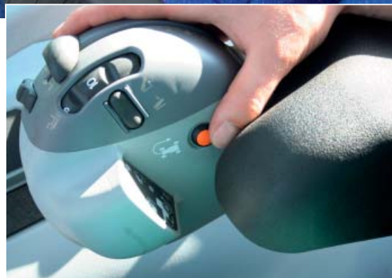
Устройство управления EHR. Оранжевая кнопка активирует систему ведения трактора на разворотной полосе или напоминающее устройство числа оборотов.
