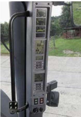
Все дисплеи расположены на правой стойке, а не на доске приборов. Только цифры на нижнем мониторе очень малы.
