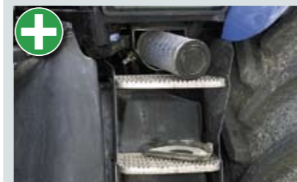
Очиститель воздуха в кабине хорошо доступен.
