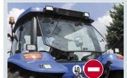
Заднее окно открывается только на „цель” и при маневрировании ослепляет
