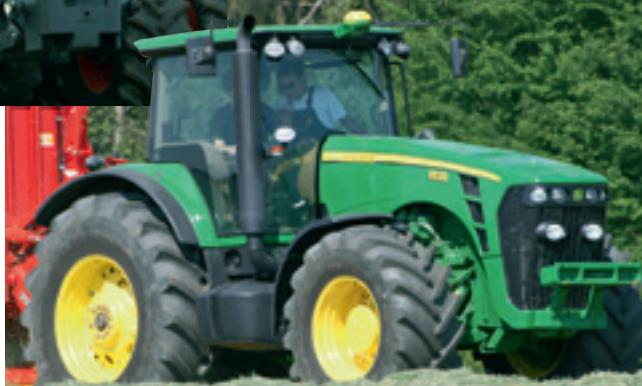
в коробке передач уменьшается, и уже при достижении 30% максимальной скорости коробка передач располагает значительными резервами крутящего момента. Система регулирования мощности (Power Management) позволяет использовать эти резервы крутящего момента, поскольку, начиная с определенной скорости или передачи, высвобождаются дополнительные мощности двигателя.
