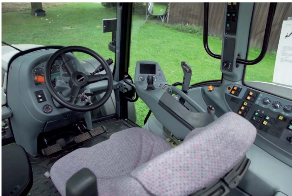
Монитор на подлокотнике показывает важнейшие настройки. Обозначения клавиш на консоли нуждаются в улучшении.
