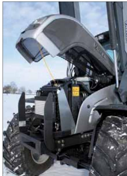
Трактор N 111 фирмы «Валтра» с четырехцилиндровым (4,4 л) двигателем, оснащенный механическим топливным насосом. На N 121 и N 141 установлены «коммонрэйл» и «пауэрбуст».
