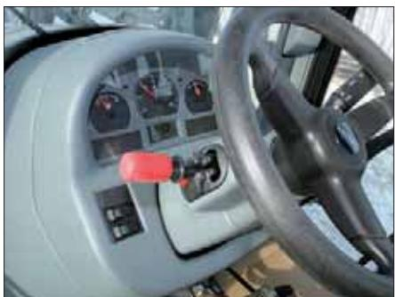
Теперь серийно в исполнении «Хайтек»: очень удобно в управлении переключаемое под нагрузкой реверсивное устройство с интегрированным стояночным тормозом
