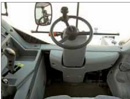
Устройство для работы задним ходом Twin-Trac. Рулевое колесо расположено теперь посередине. Отсюда же приводится в действие тормозная система прицепа.
