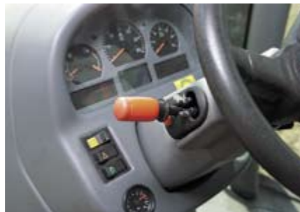
Приборная доска и стояночный тормоз, встроенный в рычаг реверсивного переключателя - характерная черта техники Valtra
