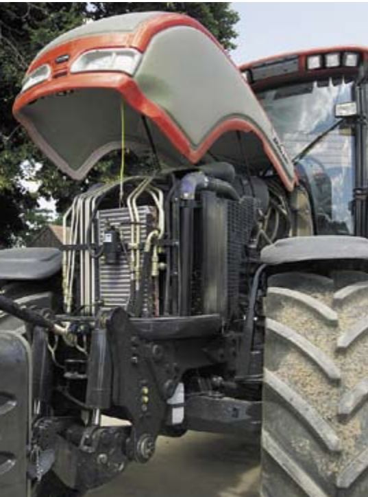
Двигатель Sisu с объемом 8,4 л выдал неплохие показатели мощности, и даже сумел обуздать свою жажду к ДТ. В капоте снимаются боковые части.
