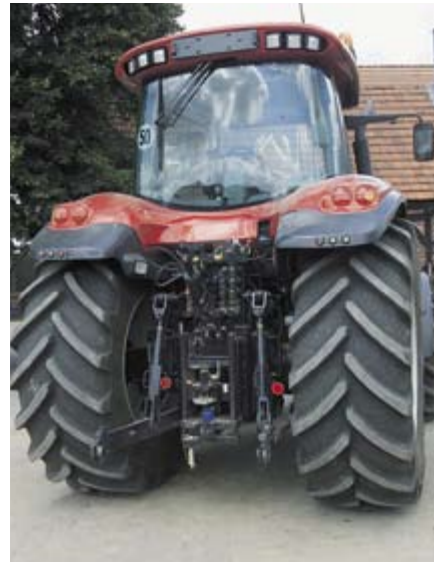
Грузоподъемности, как правило, хватает, гидравлическая мощность для 10 (!) управляющих механизмов очень хорошая. Кабина расположена на рессорах, окно не открывается.
