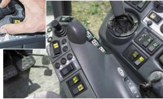
Пульт управления на подлокотнике слишком перенасыщен – всего более 20 кнопок и ручек и требует, нелепой акробатики пальцев, например, при плавающем положении.
