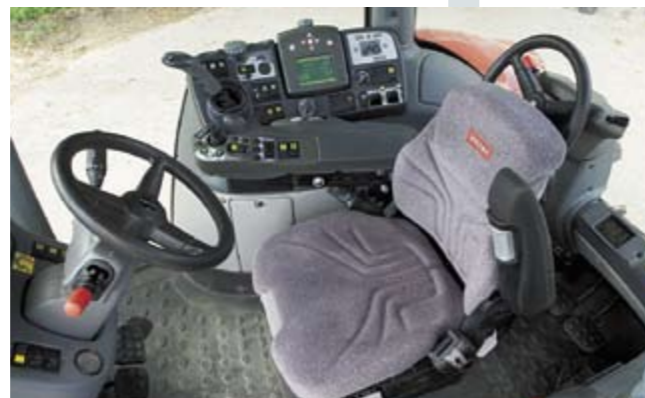
Кабина – просторна с хорошим обзором, но при показателе 79,4 дБ(А) там довольно шумно.
