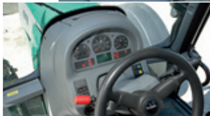
Переключатель реверсирования с интегрированным гидравлическим стояночным тормозом находится слева под рулевым колесом.
