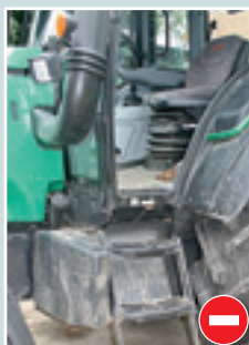
Без защиты: при работе на поле лестничный подъем полностью загрязняется.
