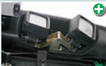
С регулированием: фары рабочего освещения имеют достаточный диапазон вращения.
