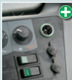
С выключателем: достаточно количество штепсельных розеток, две из них даже с выключателем.
