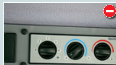
Без автоматики: вентилятор кабины имеет теперь четыре ступени. Автоматический кондиционер опционально.
