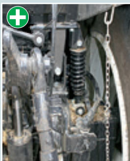
С подвеской: амортизация кабины предоставляет достаточный комфорт.
