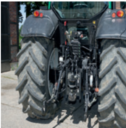
Хорошая подъемная сила 6000 даН, правда наибольшая подъемная сила лежит не в верхних, а в нижних пределах.
