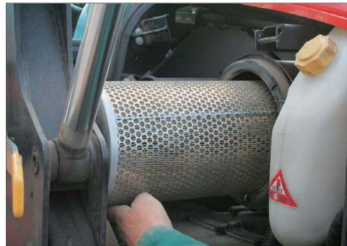
Воздушный фильтр расположен за большим боковым капотом. При навешенном фронтальном погрузчике крышку капота демонтировать затруднительно. С 2008 г. на тракторе устанавливается цельная крышка капота.
