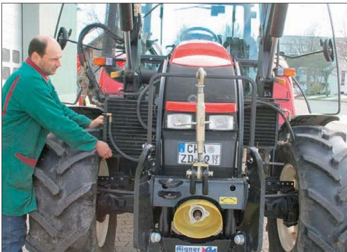
После съема передней боковой крышки капота легко выдвигаются радиаторы охлаждения. За счет этого обеспечивается легкая и удобная очистка радиаторов-охладителей кондиционера, масла трансмиссии, наддувочного воздуха и охлаждающей воды.
