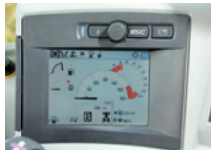
Центральный поворотный/кнопочный выключатель позволяет с легкостью переключаться между различными уровнями меню.
