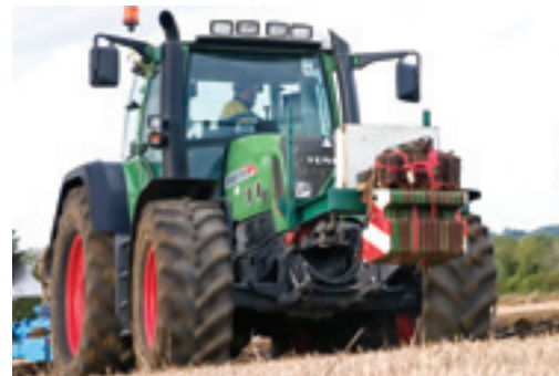
Характеристики машин определялись в условиях реальной работы на поле. Расположенная в задней части трактора специальная измерительная рама фиксирует фактическую тяговую силу.
