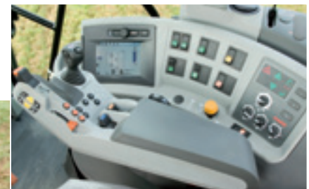
Выключатель VOM тоже должен быть расположен в подлокотнике.
